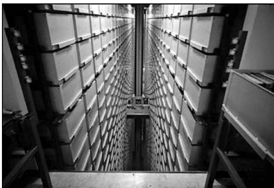
自動書庫の先例：カリフォルニア州立大学ノースリッジ校 3層分の高さに積み上げられたラックが6セットあり、請求された図書を入れた箱が自動的に取り出される
