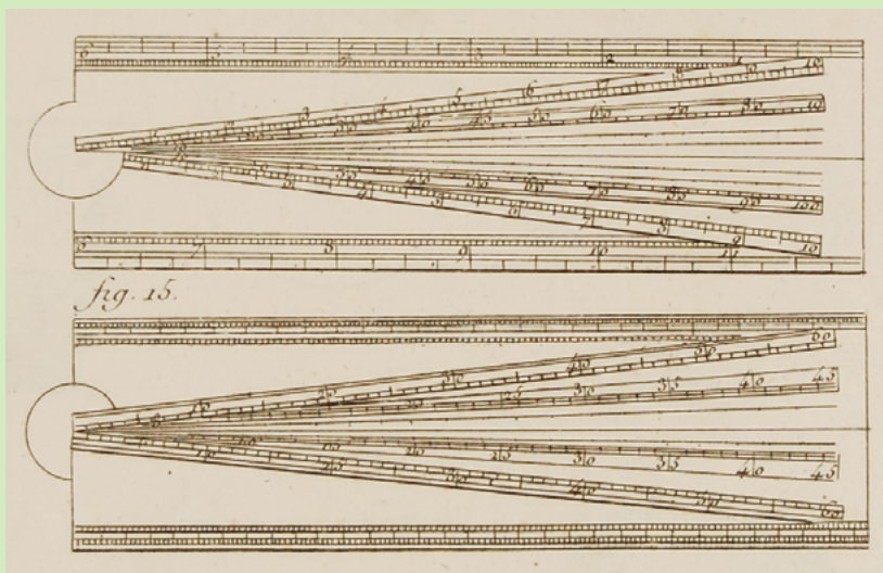
図12 セクター（計算尺） 図版5巻より
